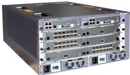
Широкополосный сервер удаленного доступа BRAS большой емкости с тесно интегрированным Hierarchical QoS и унифицированным доступом клиентов и функциями управления.
